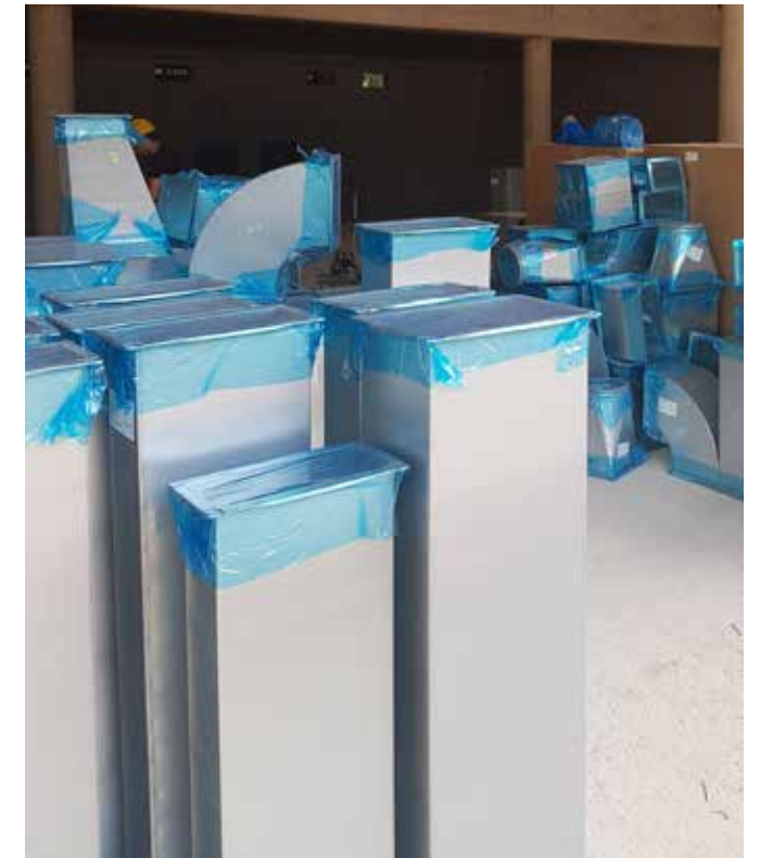
Inmiddels wordt circa 10 tot 15% van de luchtkanalen grondig gereinigd, gefolied en afgeplakt, alvorens ze de fabriek van Vink Systemen in Katwijk verlaten.
